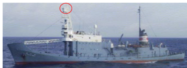
図7. トップバレルを有する鯨類目視調査船 (赤丸内がトップバレル)
