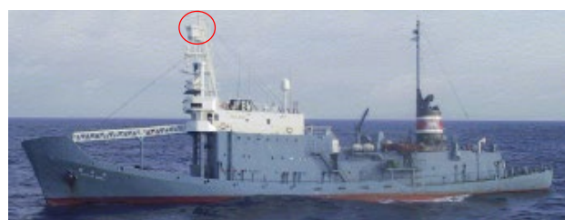
図 7. トップバレルを有する鯨類目視調査船（赤丸内がトップバレル）
