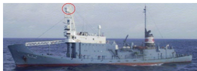
トップバレルを有する鯨類目視調査船(赤丸内がトップバレル)
